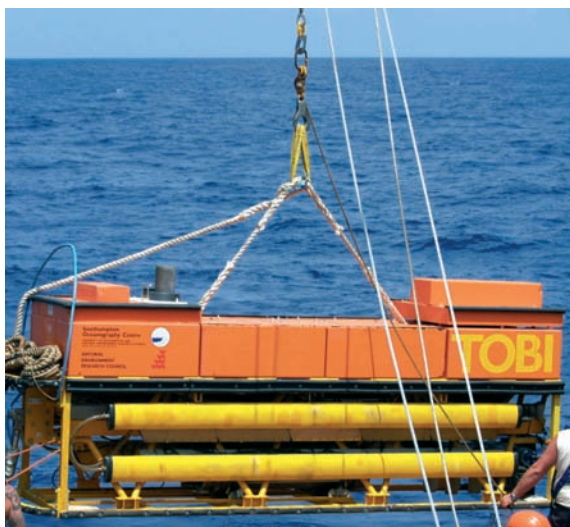
Foto 3.10: El TOBI (Towed Ocean Bottom Instrument) es uno de los sonares de barrido lateral del Reino Unido utilizados para obtener mapas acústicos del fondo marino profundo
